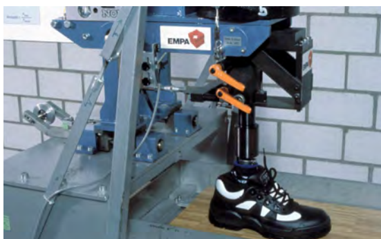
Figura 1 Apparecchio per test di pavimenti e scarpe BST 2000, EMPA San Gallo
